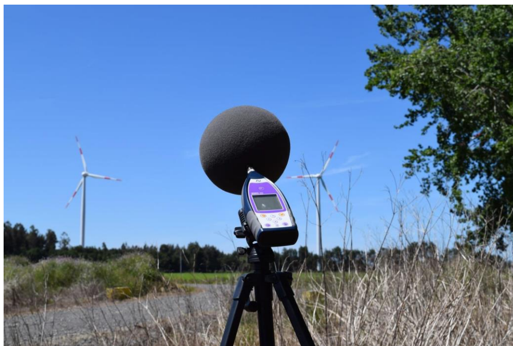
Fotografía 1. Ejemplo de pantalla anti-viento para la medición del ruido de parques eólicos.
